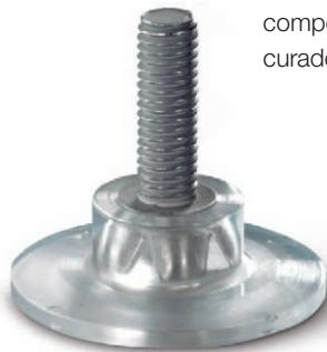
Unión rápida con adhesivos que permite la fijación de elementos de muy diferentes materiales. Los elementos de fijación con una base de plástico transparente se pegan en el componente utilizando un adhesivo de curado por luz.
